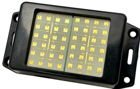
定在波レーダとしては 従来の 24GHz FMCW Radar の性能限界を超える高精度な距離測定が可能。
