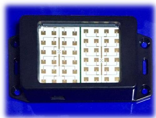
従来の 24GHz Radar 性能を超える高精度な距離測定が可能。
