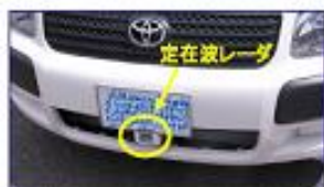
■ 衝突防止用車載レーダとしての使用を想定した実験
