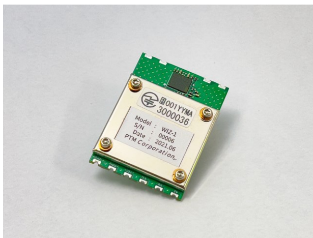
外形寸法30×40.64mm 端面スルーホールタイプ
