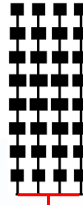
直列8素子x4列 パッチアンテナ Gain = 16 dBi typ
