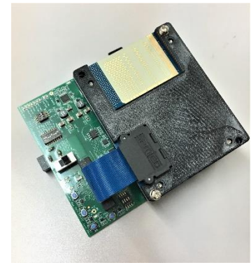
DCA1000EVM((別売) Texas Instruments 製キャプチャボードとの 接続イメージ
